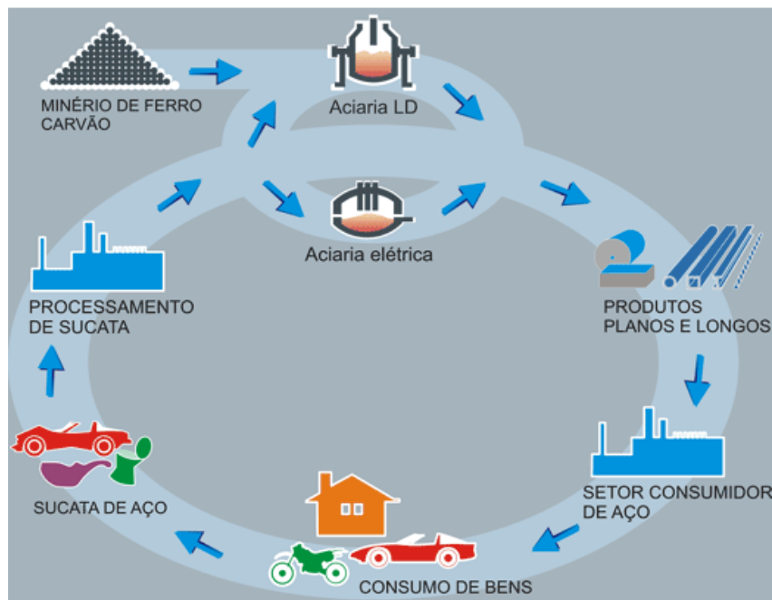
Figura 19: Fluxo da Reciclagem do Aço (fonte: IBS)
